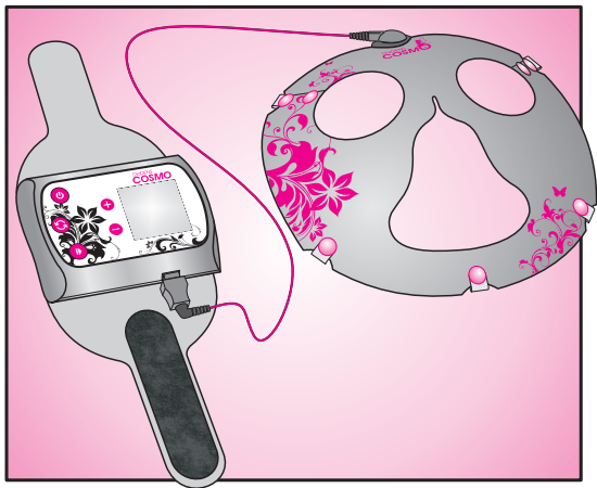
Рис. 6. Косметологический аппарат с подключенным электродом-маской
